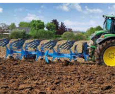
Der Juwel 6 ist für Traktoren von 70 bis 130 PS geeignet.
